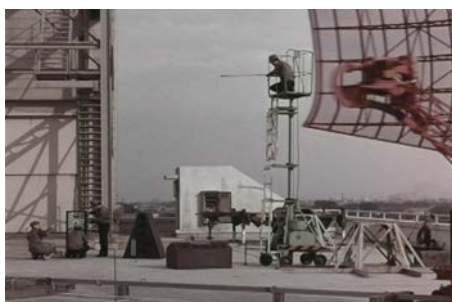
ドーム内での音の広がりを検討するための音響テスト風景
